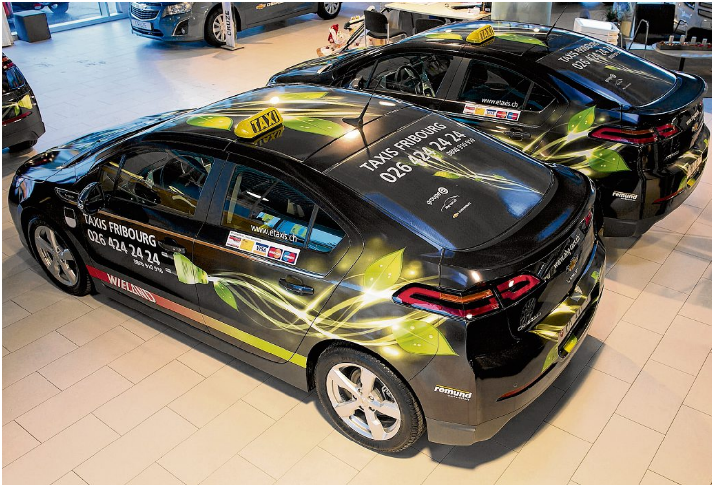
Ist die Batterie des Elektro-Taxis erschöpft, erzeugt ein Benzingenerator Strom.
